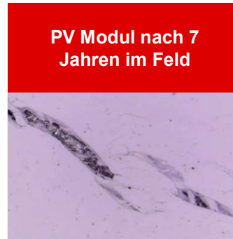
Beschichtung und beschleunigte Alterung von Modulen mit tiefen Rissen, Quelle OFI, PCCL
