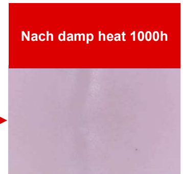
Beschichtung und beschleunigte Alterung von Modulen mit tiefen Rissen, Quelle OFI, PCCL
